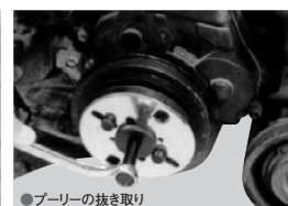
●プーリーの抜き取り
