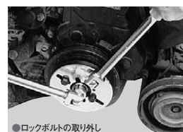
●ロックボルトの取り外し
