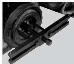
●トヨタ車等のネジ穴が付いているプーリーは、ヨークボルトを取り付けて外してください。 (D=48~108)
