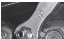
シリンダー固定ボルトを回避するために「くびれ」を設計。
