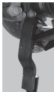
● 隙間形状により斜めに入れて入れることで装着できる車種もあります。
