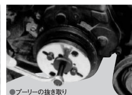
●プーリーの抜き取り
