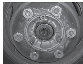
●ハブに3箇所又は3の倍数でM10P1.5のサービススタップが切れている車両に対応します。
