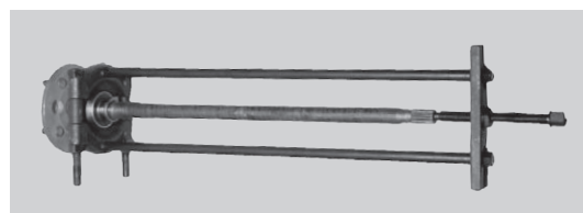
●別売品:ヨークボルトを利用してリヤシャフトベアリングの抜き取り(カラーはグラインダー・タガネ等で切断して取外してから使用してください。)
