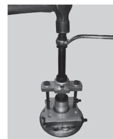
●ハンマーで「叩く」レンチで「回す」の繰り返し作業で
