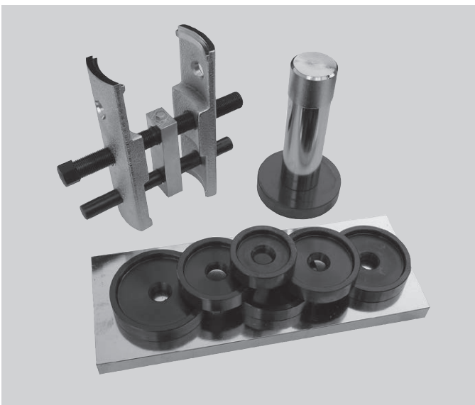
●プッシュホルダーの幅を調整してナックル形状に合わせて、ベアリングを抜き取ります。
