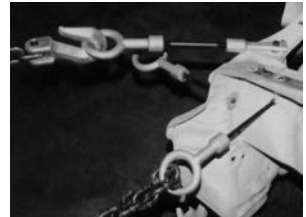
●8mmリング及びサイドフックを利用した多方向引き作業
