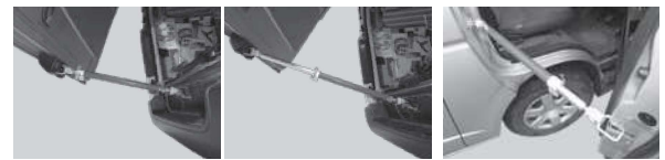
●270mmの伸縮で作業しやすい所で保持します。 ●ドアのロック部を使用するので確実にロックします。
