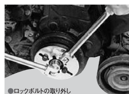
●ロックボルトの取り外し
