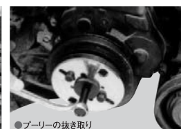
●プーリーの抜き取り
