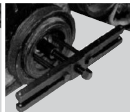
●トヨタ車等のネジ穴が付いているプーリーは、ヨークボルトを取付け外してください。 (D=48~108)
