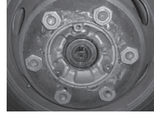
●ハブに3箇所又は3の倍数でM10P1.5のサービスタップが切れている車両に対応します。
