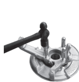
●ベアリング抜き取り例
