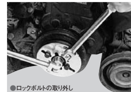
●ロックボルトの取り外し
