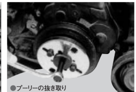
●プーリーの抜き取り
