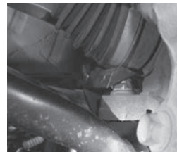
●隙間形状により斜めに入れて入れることで装着できる車種もあります。
