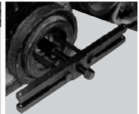
●トヨタ車等のネジ穴が付いているプーリーは、ヨークボルトを取り付けて外してください。 (D=48~108)
