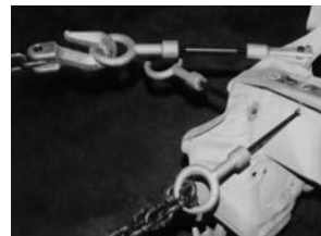
●8mmリング及びサイドフックを利用した多方向引き作業
