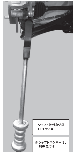
●隙間形状により斜めに入れて入れることで装着できる車種もあります。
