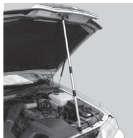
●ボンネットのダンパー交換時の閉まり止めとして。
