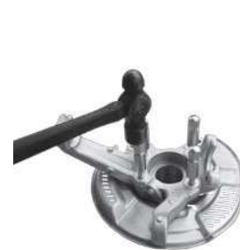
●ベアリング抜き取り例
