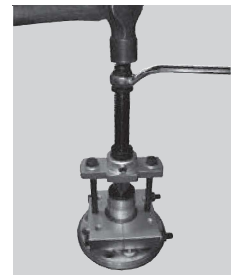
●ハンマーで「叩く」、レンチで「回す」の繰り返し作業で
