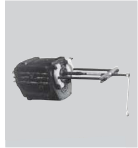
●トランスミッションベアリング抜き取り
