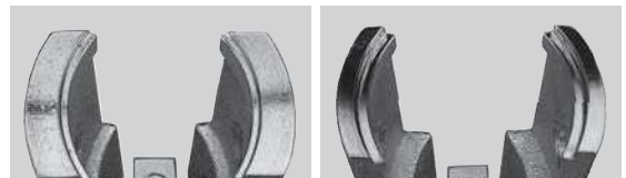
●両端の端面はナックルの内径や外径に合わせられる様に異なる形状になっています。
