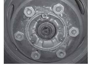
●ハブに3箇所又は3の倍数でM10P1.5のサービススタップが切れている車両に対応します。
